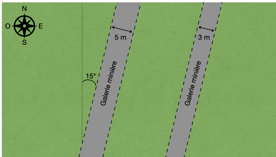
Figure 2 – Vue aérienne du site de construction au-dessus de galeries minières enfouies.
